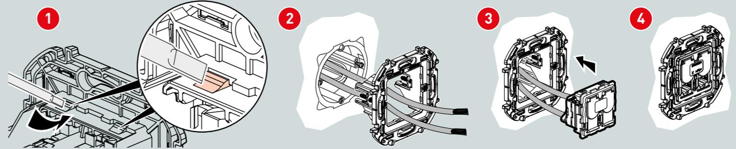
ПРИСОЕДИНЕНИЕ КАБЕЛЯ БЕЗ СПЕЦИАЛЬНЫХ ИНСТРУМЕНТОВ
